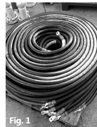
Fig. 1 - Le câble d'alimentation de 400 volts, 409 ampères, 5 pôles. Câble d'un minimum de 95 mm 2 x 4. Aucun câble neutre requis. En cas de câble plus longue de 50 mètres, contactez Andrews Sykes.
